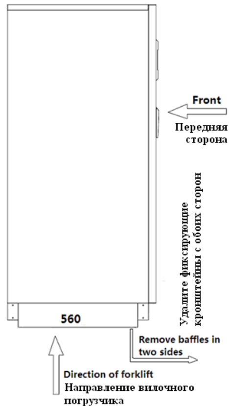
Рис. 3-7: Модели 60~120кВА: схема транспортировки [размеры указаны в мм]
