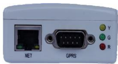
Рис 7-1 Вид SNMP адаптера iStars со стороны сетевого разъёма (Внешний SNMP адаптер / External Card)
